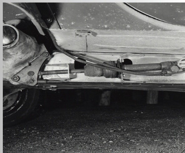
Slika zgoraj: Prvi model opremljen z hidravličnim vzmetenjem je bil eden izmed prototipov 2CV iz leta 1946.
