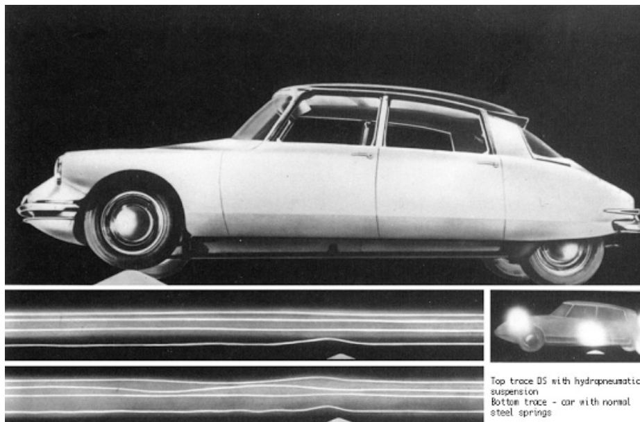
Slika zgoraj: Prikaz absorbiranja prevožene ovire pri hidravličnem in pri klasičnem vzmetenju.
