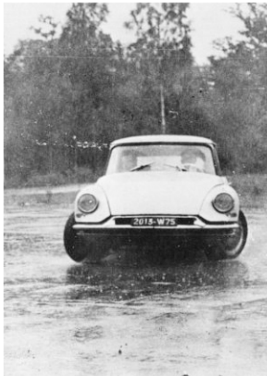
Slika zgoraj: ista hitrost, isti zavoj z sistemom proti nagibanju
